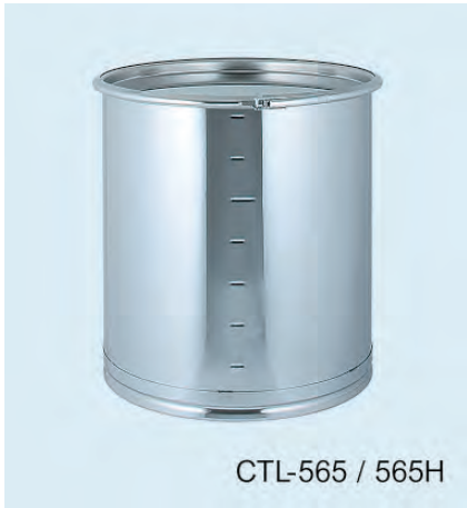
CTL-565, 565H的容量分别为150L和200L, 在桶身每20L处设有刻度, 并在底部设有凹陷防止的保护圈。
